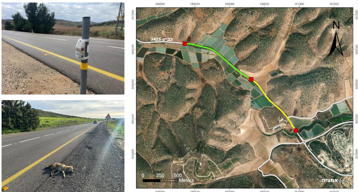
איור 1. פיילוט מערכת iPTE בכביש 3415. (א) אזור הפיילוט. בצהוב מסומן מקטע הכביש בו הוצבו המכשירים (מקטע הניסוי). בירוק מסומן מקטע הכביש בו לא הוצבו המכשירים (מקטע הביקורת). (ב) אחד ממכשירי המערכת מותקן על עמוד ליד הכביש. צילום: תומר עופרי. (ג) תן דרוס בכביש 3415. צילום: תומר עופרי.
